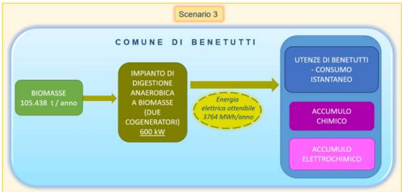
Figura 27: Installazione di due cogeneratori della potenza complessiva di 600 kW
