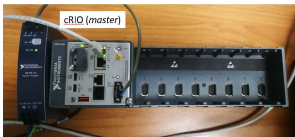
Figura 14: cRIO controller con funzione di master
