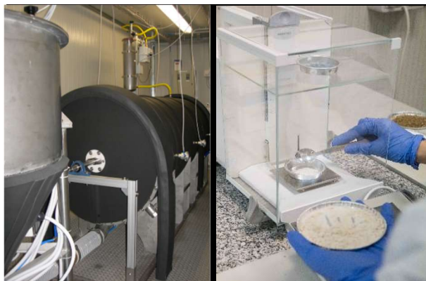
Figura 19: L'impianto pilota di digestione anaerobica e le attività analitiche per la gestione del processo
