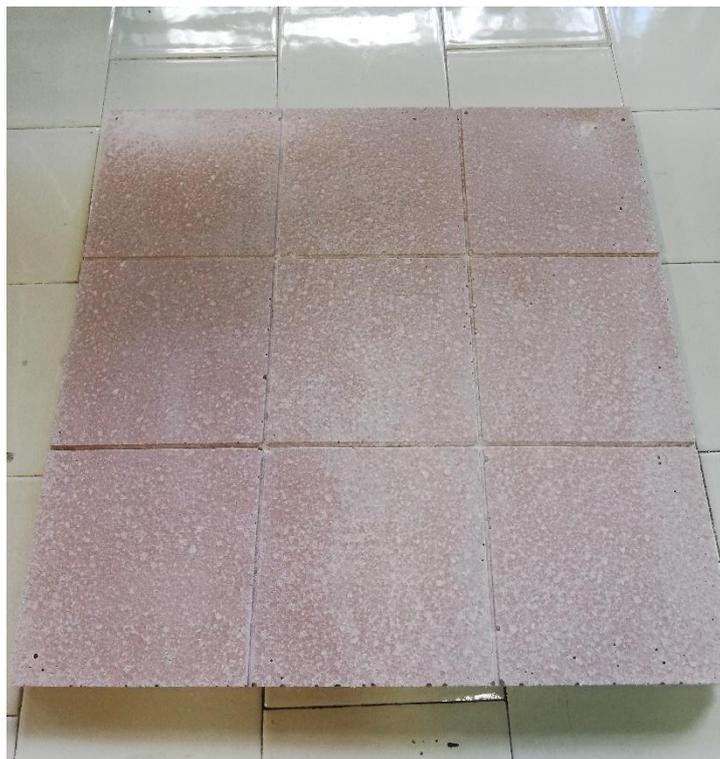
Figura 1. Mattonella contenente 75% di marmo granulare e 25% di metacaolino.
