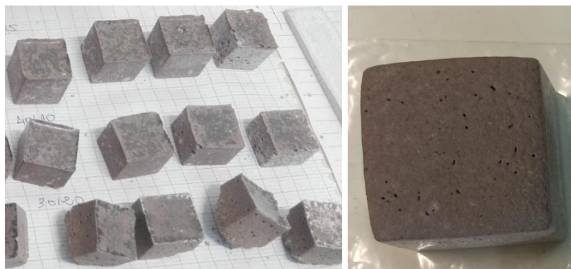
Figura 3. Esempi di geopolimero porosi ottenuto seguendo il presente protocollo.
