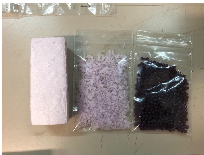
Fig1. : da sinistra a destra, polistirene espanso derivante dal taglio di pannelli isolanti Isolex; Scarto tritato; polistirene rigenerato da impianti Isolex.
