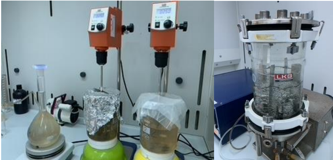
Figura 7. Preparazione terreno con TAR per esecuzione prove di degradazione in reattore biologico (sx) e reattore biologico per test di degradazione reflui (dx)
