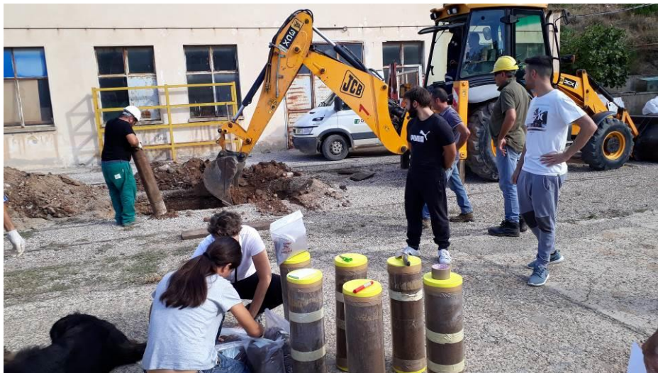
Immagine 2 - Prelievo di campioni per esperimenti di decontaminazione (Masua – IGEA spa)
